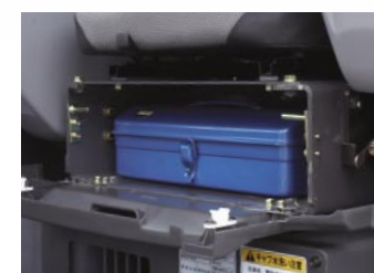
シート下に大型工具箱を設置
